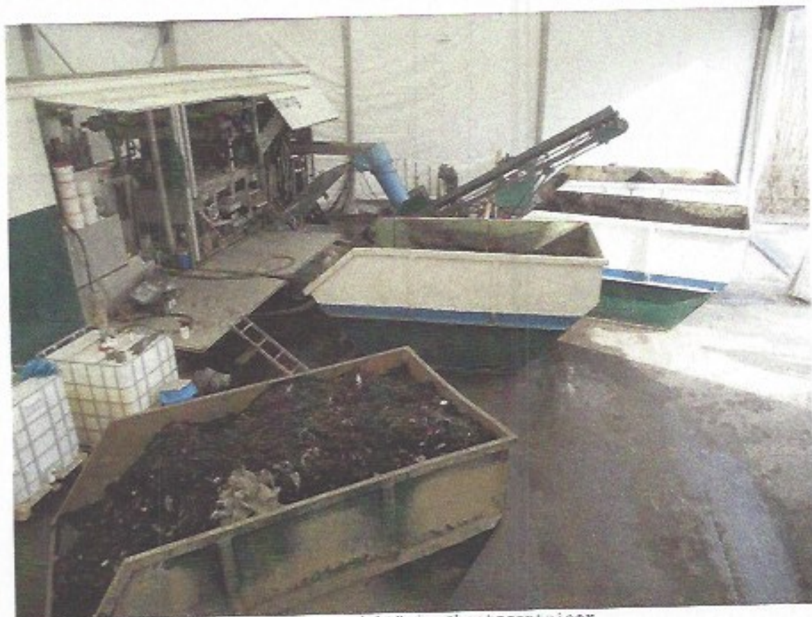
Siebbandpresse mit Auswurf „Endprodukt“ in Absetzcontainer
