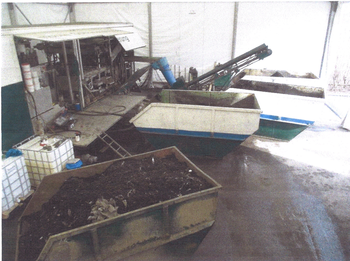
Siebbandpresse mit Auswurf „Endprodukt“ in Absetzcontainer
