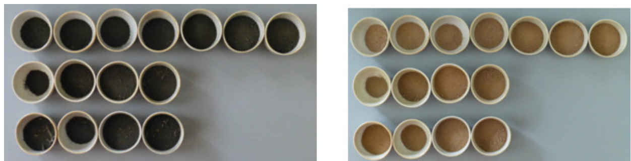
Abb. 12: Getrocknetes und im Mörser homogenisiertes Sediment (links) und bei 550 °C geglühtes Sediment (Glührückstand = mineralische Bestandteile) (rechts) aus dem Waldsee (Zehlendorf)
