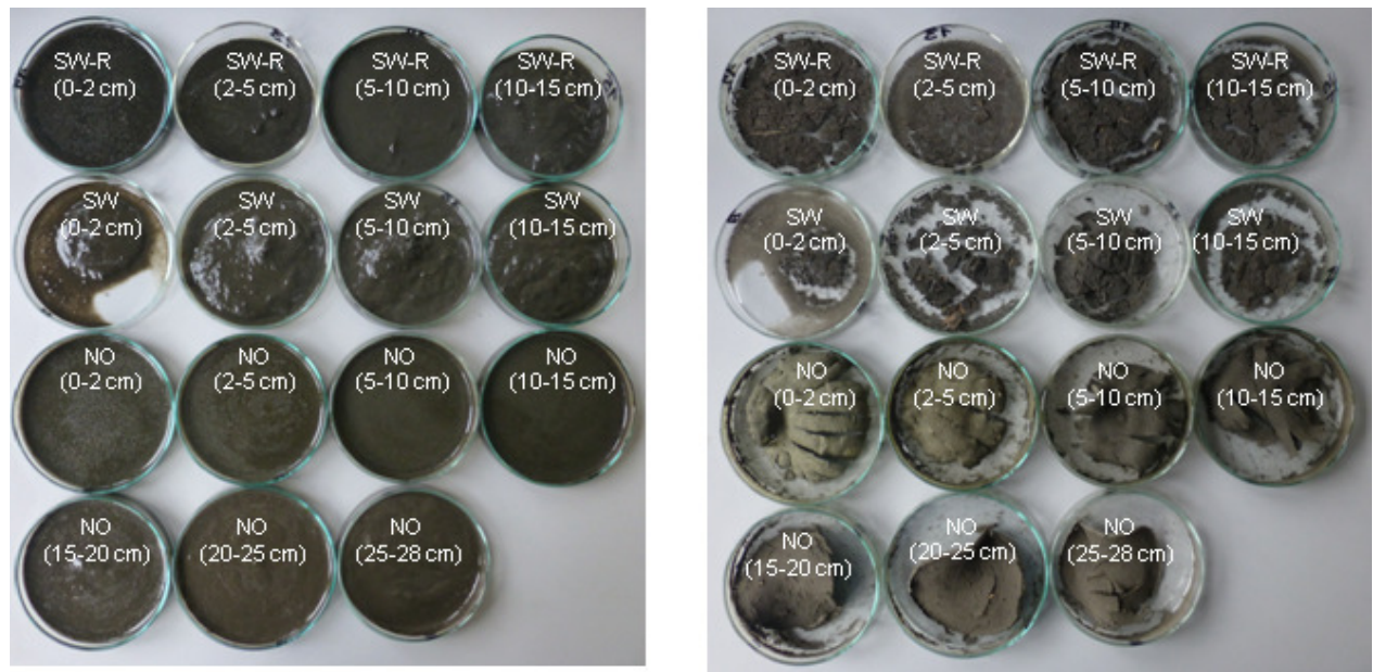
Abb. 11: Feuchtsediment (links) und bei 105°C getrocknete Sedimentschichten (rechts) aus dem Waldsee (Zehlendorf)
